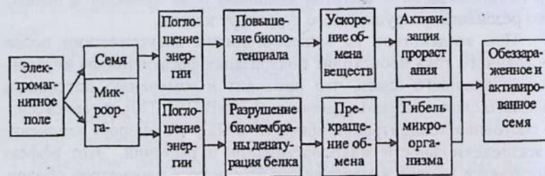
Рисунок 6.9. Схема протекания процессов при обеззараживании семян в электрическом поле
