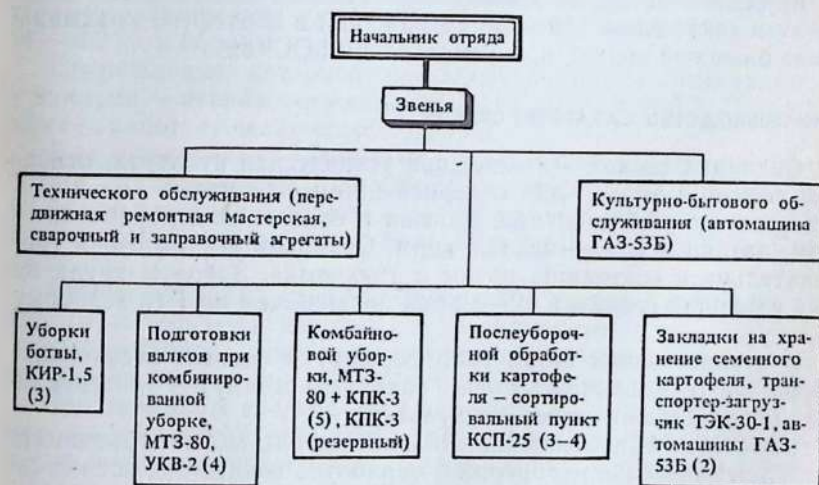
Рис. 5. Состав и техническая оснащенность уборочно-транспортного отряда на уборке картофеля с 200—250 га.
