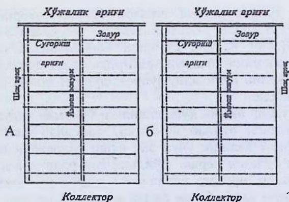
8.7.1.7-расм. Суғориш ва коллектор - зовур тармоқ-ларининг жойлашиши: а-шоҳ ариқлар бир томонлама сув берганда; б-шоҳ ариқлар икки томонлама сув берганда.
