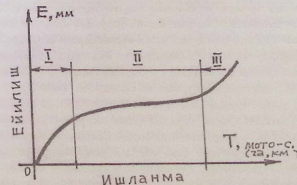
2.1-расм. Механик ейилиш (Лоренц эгри чизиги) графиги: I—давр — чиниктириш жараёнидаги ейилиш; II — давр — нормал фойдаланиш жараёнидаги ейилиш; III — давр — аварияли ҳолатга келгандаги ейилиш.
